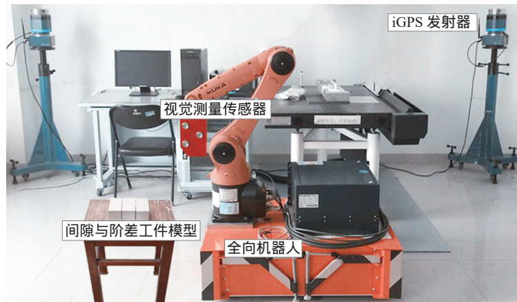
图8 现场测量试验场景
